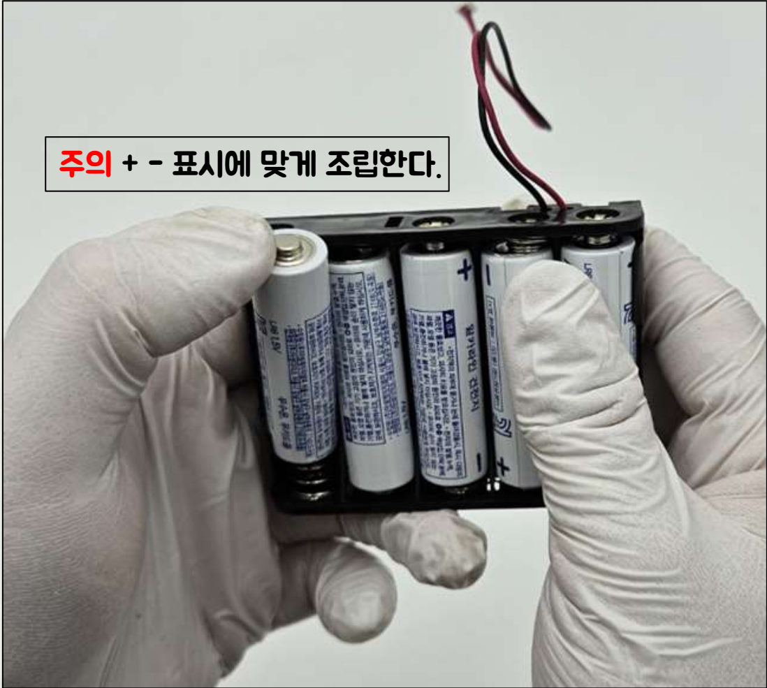
[배터리]를 [배터리 케이스]에 조립한다.
