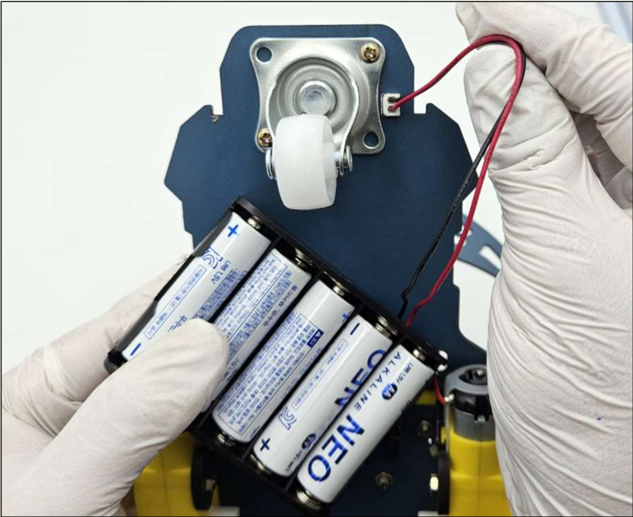
[배터리 케이스]의 전선을 [하판]의 [캐스터 휠]옆에 있는 직사각형 구멍에 통과시켜 빼준다.
